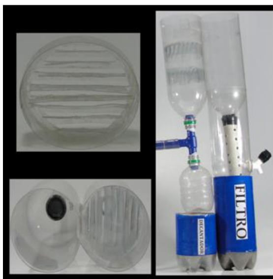
Figura 5 - Decantador e Filtro
