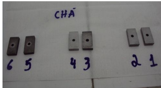
Figura 2: Corpos de prova limpos e pesados após ensaio de perda de massa. Os corpos de prova 1 e 2, 3 e 4, 5 e 6, foram usados, respectivamente, nos ensaios contendo 100 ppm, 200 ppm e 300 ppm do extrato do chá-branco.
