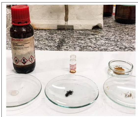
Figura 6. Ensaio de identificação para alquinos empregando o reagente de Tollens. A esquerda fenilacetileno que forma precipitado branco, no meio uma alíquota da mistura reacional, e a direita o produto isolado que é insolúvel e não reage.
