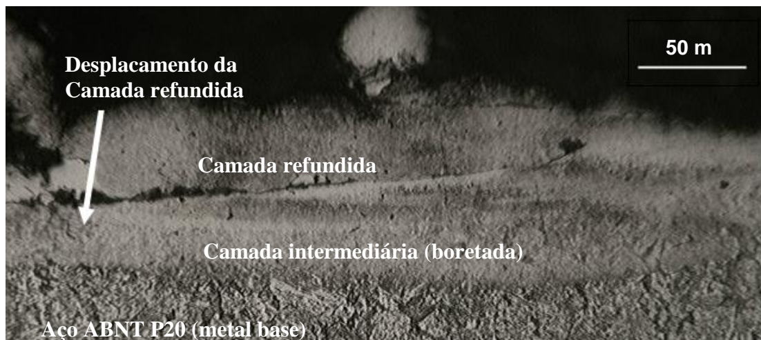
Figura 5. Imagem da seção transversal da amostra após usinagem por EDM do aço ABNT P20.
