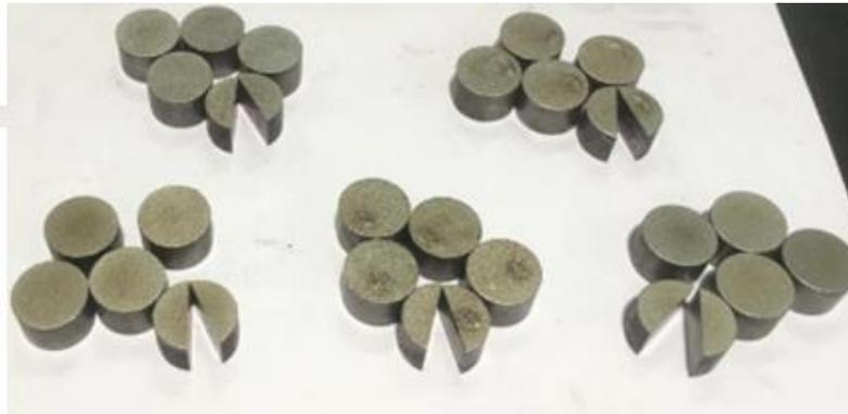
**Figura 2.** Amostras do aço ABNT 4140 usinados por EDM. **Fonte:** Autor, 2021.
