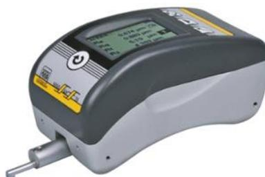
**Figura 9.** Rugosímetro utilizado na medição das rugosidades das amostras. **Fonte:** Autor, 2021.
