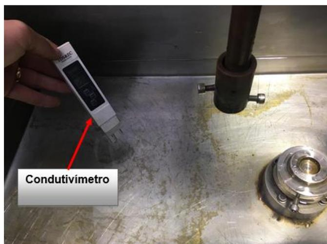
**Figura 8.** Realização da medição da condutividade do fluido dielétrico.
