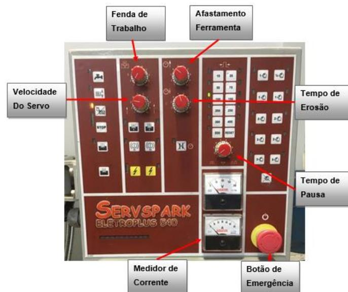
**Figura 7.** Painel de controle da máquina de EDM. **Fonte:** Autor, 2021.
