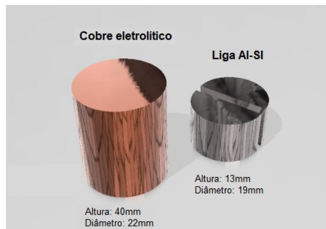
Figura 3. Representação dos eletrodos de cobre eletrolítico e de liga alumínio-silício com suas respectivas dimensões.
