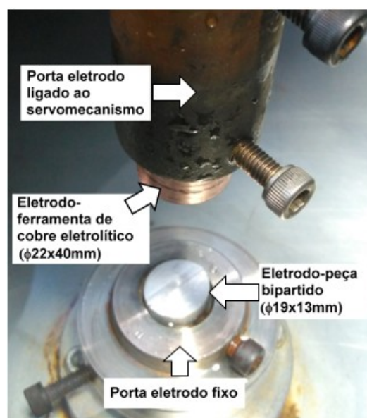
Figura 4. Eletrodos fixados ao equipamento.
