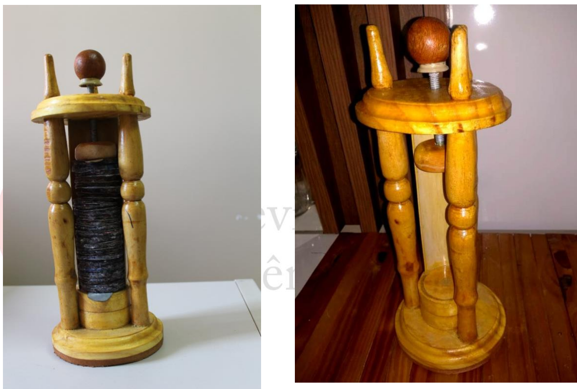
Figura 3: Terceira pilha construída. Pra manter a coluna de células estável e pressionada, foi introduzido o “general” e um suporte cilíndrico (feito de cano de PVC) entre duas das hastes de madeira. Pra essa pilha, as placas podem ter área menor, mas é possível aumentar o número de células, o que levava a uma corrente maior e mesma tensão que na pilha dois.
