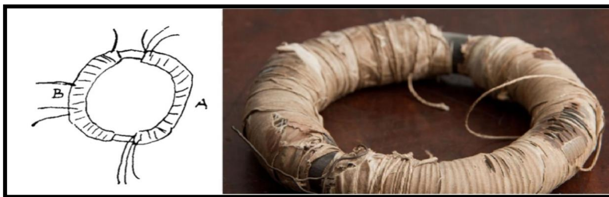
Figura 5: Esboço do experimento que possibilitou Faraday induzir corrente elétrica a partir da eletricidade voltaica (presente em seu diário), e foto do real anel utilizado (guardado atualmente no The Faraday Museum , em Londres)
