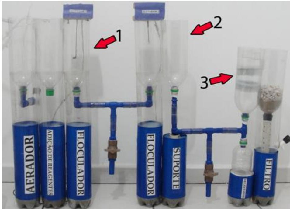
**Figura 3 - Tanques de processamento**
