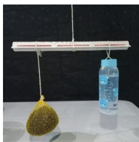
Figura 9: O procedimento é repetido com uma amostra de menor densidade Fonte: elaborada pelos autores.
