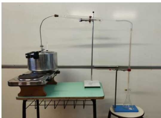
Figura 2: Destilador por arraste a vapor construído com materiais acessíveis
