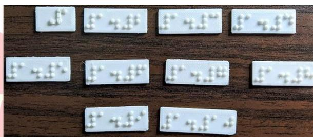
**Figura 9:** Protótipo final das legendas em braile
