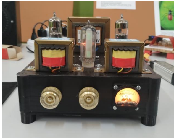
Figura 11: Acabamento final do amplificador desenvolvido com botões ("knobs") de guitarra. Fonte: Elaborada pelos autores.
