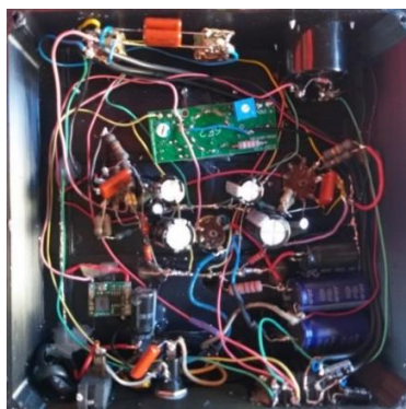
Figura 8: Ligação das peças por terminais e fios Fonte: Elaborada pelos autores.
