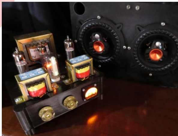
Figura 12: Amplificador em funcionamento com a caixa acústica construída em MDF. Fonte: Elaborada pelos autores.
