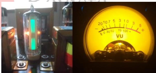
Figura 7: Válvula "olho mágico" e para o outro um VU, "Volume Unit"
