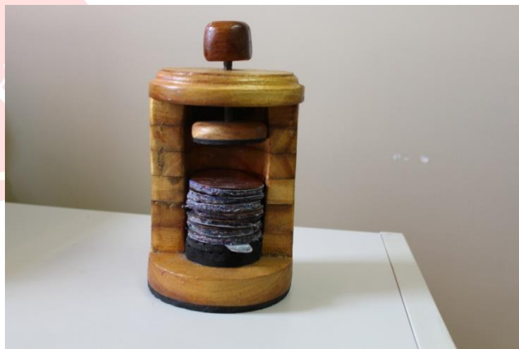
Figura 2: Segunda pilha construída. As placas são mais largas (maior área de contato), não possuem um furo central, e são empilhadas num entalhe feito na madeira. Um parafuso (nome técnico "general") é rosqueado e prende a pilha entre os dois contatos de metal que fazem a ligação com o circuito.
