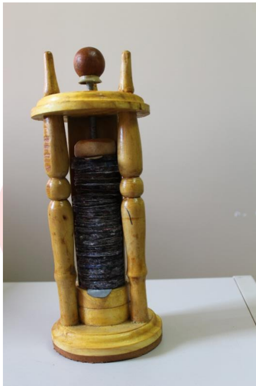
Figura 3: Terceira pilha construída. Pra manter a coluna de células estável e pressionada, foi introduzido o "general" e um suporte cilíndrico (feito de cano de PVC) entre duas das hastes de madeira. Pra essa pilha, as placas podem ter área menor, mas é possível aumentar o número de células, o que levava a uma corrente maior e mesma tensão que na pilha dois.
