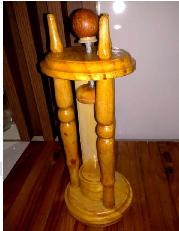
Figura 3: Terceira pilha construída. Pra manter a coluna de células estável e pressionada, foi introduzido o "general" e um suporte cilíndrico (feito de cano de PVC) entre duas das hastes de madeira. Pra essa pilha, as placas podem ter área menor, mas é possível aumentar o número de células, o que levava a uma corrente maior e mesma tensão que na pilha dois.
