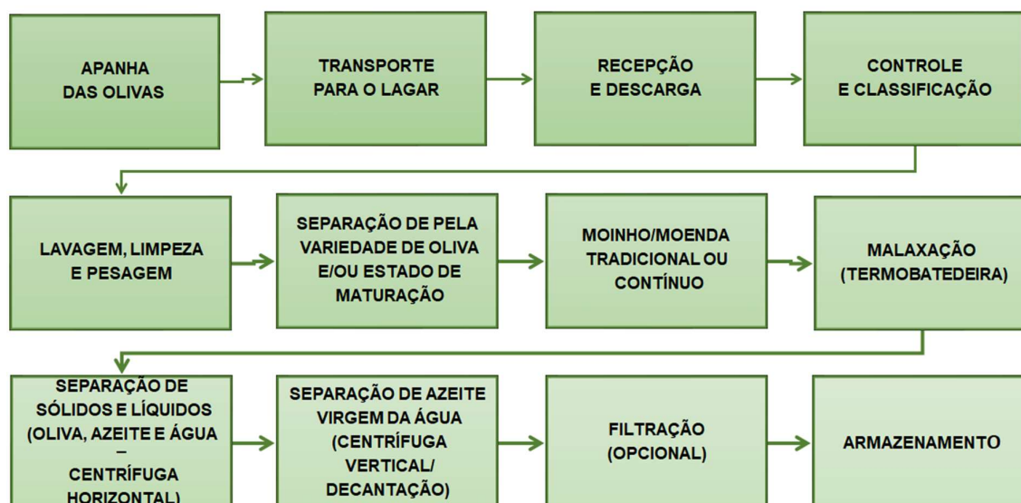
Figura 1. Processo convencional de obtenção do azeite de oliva virgem
